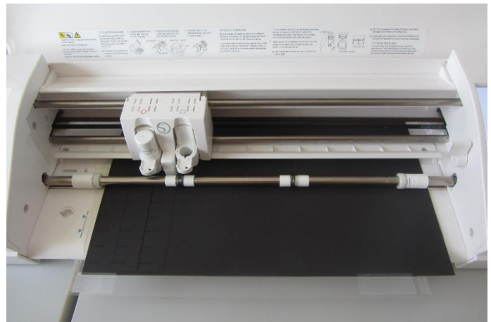
Der Plotter, der gerade die einzelnen Teile ausplottet
